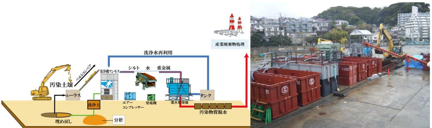
汚染土壌浄化プロセスフロー（溶出・重金属）
