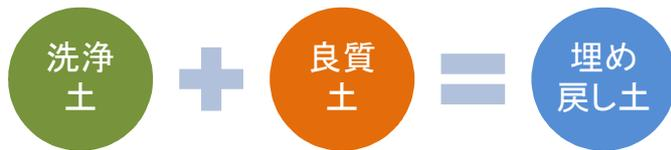
洗浄後の土壌は細粒分が減少している為に、良質土と混合して場内へ埋め戻しを行います。
